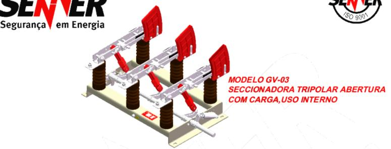
A chave seccionadora modelo GV-03, é fabricada em conformidade a norma NBR IEC 62271-102 com ação simultânea nas três fases, para uso abrigado, podem ser instaladas em cabines de alvenaria, ou painéis metálicos. Os contatos principais móveis são do tipo Dupla faca, com contatos lineares e dispostos de forma que possam suportar os esforços resultantes das solicitações mecânicas e elétricas, as partes condutoras são de cobre eletrolítico tratadas galvânicamente com estanho/ e ou prata.
